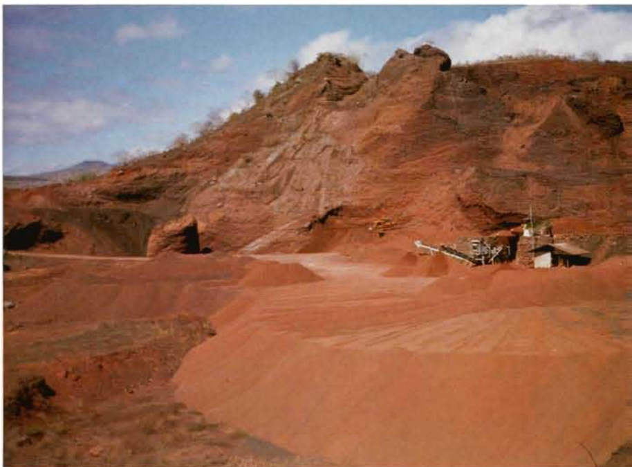
Cantera para la extracción de "ripio" (lapilli volcánico) cerca de Puerto Baquerizo Moreno, en Isabela. Estos áridos son empleados en la construcción de edificios y para cubrir carreteras.
