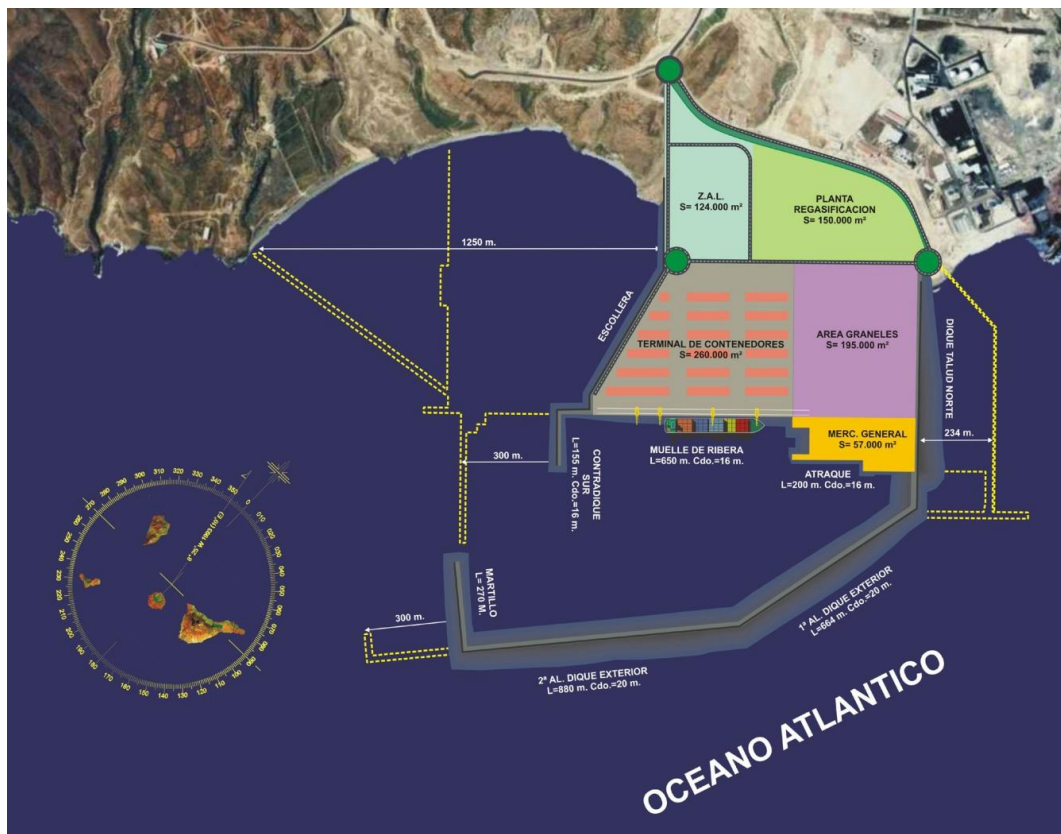
Figura 6. Proyecto final del puerto de Granadilla (2005). En trazado amarillo discontinuo la dimensión de la fase I antes de ser reducido.
