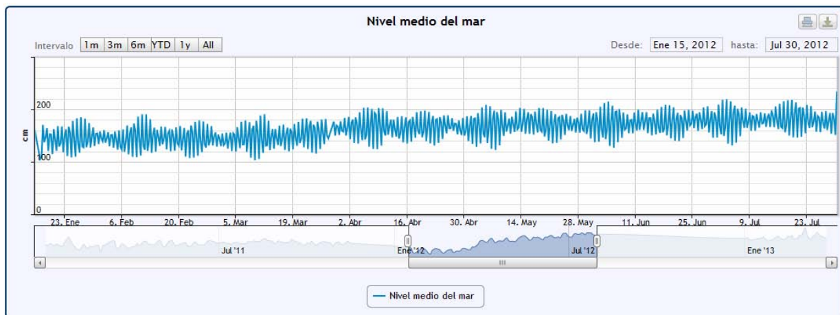
Figura 38. Registro del nivel del mar en el mareógrafo de Granadilla, de Puertos del Estado.
